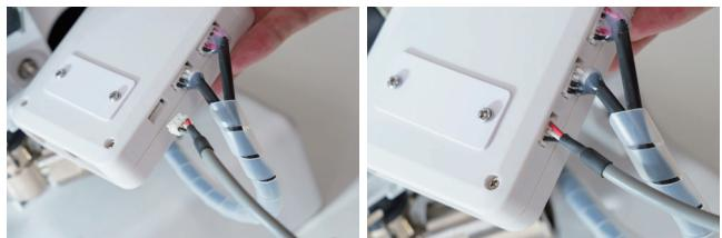
メイン基板ケースの差し込み口に、有線ケーブルを差し込みます。
