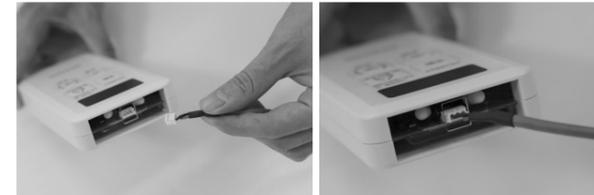
リモコン下部の差し込み口に、有線ケーブルを差し込みます。
