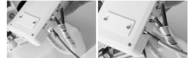
メイン基板ケースの差し込み口に、有線ケーブルを差し込みます。
